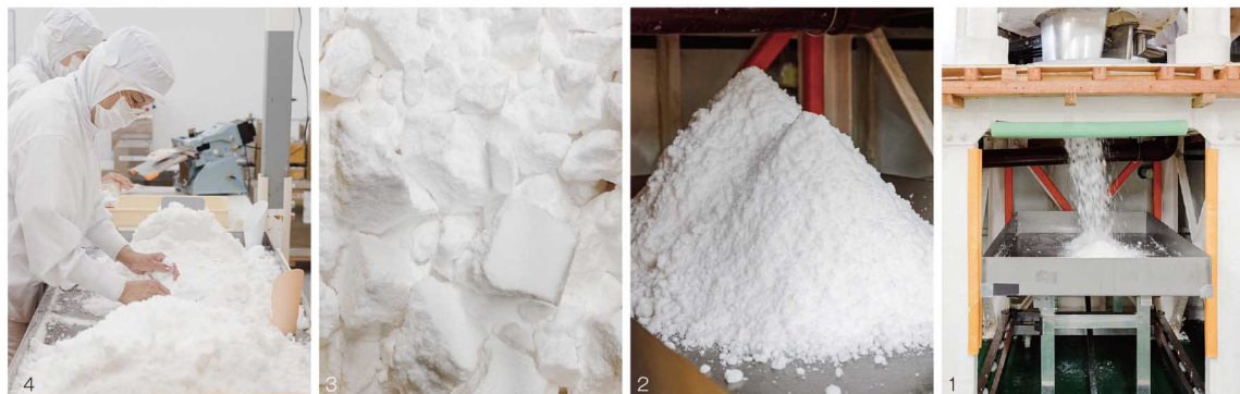
塩田から運んできた塩は、元町工場で大釜で一昼夜炊き、樽に移す（P.2写真）。1,2. 脱汁してにがりと分けると、「あらしお」になる。3. 焼成して焼き固まった「やきしお」は、ほぐすとさらさらになる。4. 目視による検品と手作業による包装。
