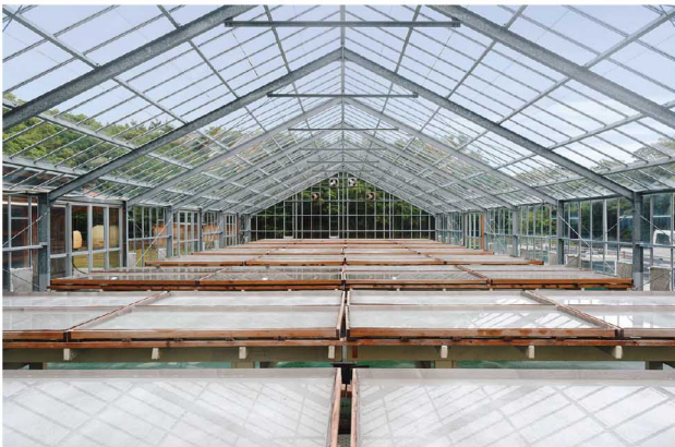
多雨多湿の日本では、太陽の力だけで結晶させる天日海塩は生産されてこなかったが、海の精では塩田と温室を用いることで国産の天日海塩づくりに成功した。「ほしお」は千波工場の天日温室で1年がかりでつくられる。特に暑い時期は、分離結晶しないよう担当者が日に何度もすべての塩を攪拌する。紙漉きのような所作が美しい。
