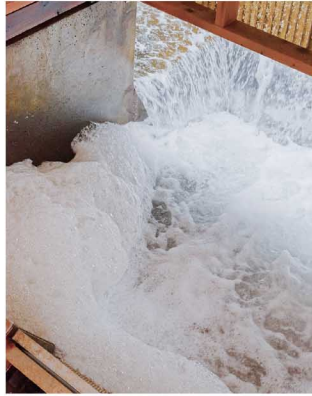
ネット架流式塩田で海水を循環させながら濃縮していく。
