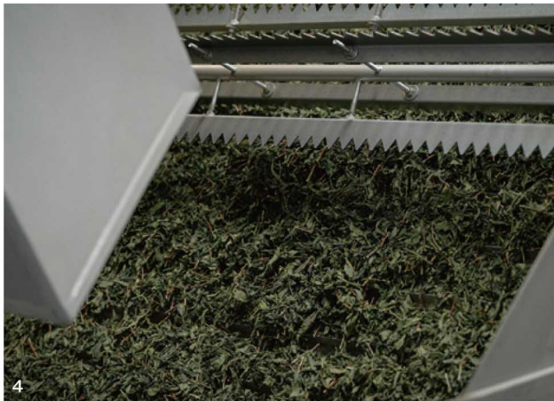
1. 茶葉を釜炒りする。 2. 揉みながら乾燥させる(相揉)。 3. おもりをつけて揉み(揉捻)、さらに熱風で揉む(中揉)。 4. さらに乾燥させ、徹底的に水分を抜いていく。
