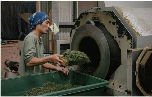
熟成した茶葉を焙煎し、三年番茶に仕上げ中。たまたま立ち寄ってアルバイトして以来10年経つという横山大樹さんは、すっかり腕のいい職人に。この年季の入った機械で、釜炒りも焙煎もできる。
