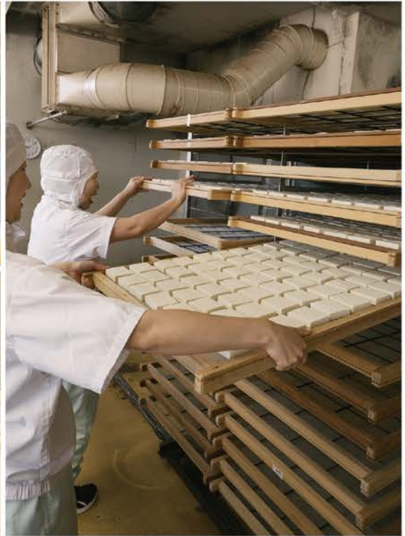
乾燥加工の前に「オーサワの高野豆腐」特有の薄さにスライス。「膨軟剤不使用だと割れやすいので、それを防ぐために薄くします」と取締役営業部長の新井健さん。また、消泡剤を使わないことで発生しやすくなる煮ムラがないか(内部まで火が通っているか)確認しやすくなるという利点も。
