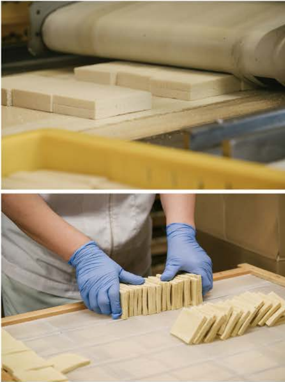
乾燥加工の前に「オーサワの高野豆腐」特有の薄さにスライス。「膨軟剤不使用だと割れやすいので、それを防ぐために薄くします」と取締役営業部長の新井健さん。また、消泡剤を使わないことで発生しやすくなる煮ムラがないか(内部まで火が通っているか)確認しやすくなるという利点も。
