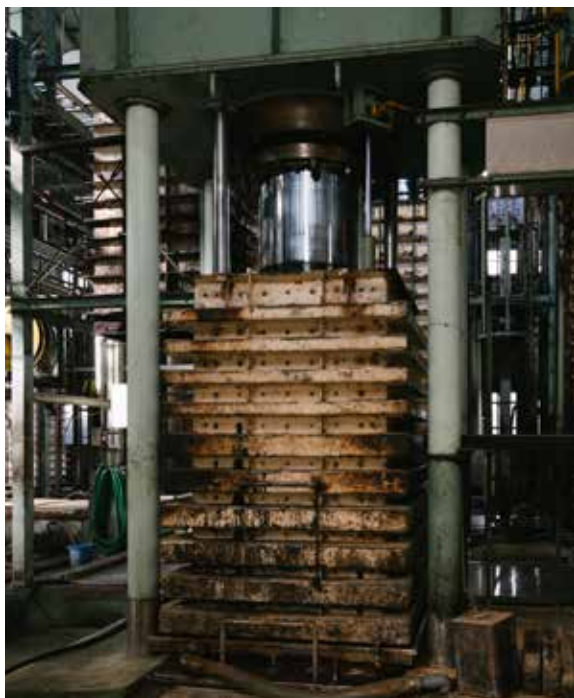
醸造した諸味と濾布を重ねて搾る圧搾という行程では、3日間をかけて醤油が抽出されていきます。 醤油になる液体と固体に分離され、搾ったあとに残る固体部分は、小豆島の農地にて肥料として活用されるそうです。 圧搾後は、製品化していくための仕上げである「火入れ」の工程へ。
