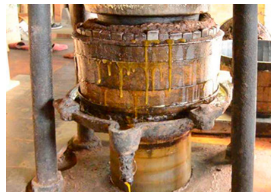
人髪マットを使って胡麻油を搾る玉締め器
